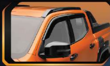
Vệ che mưa
